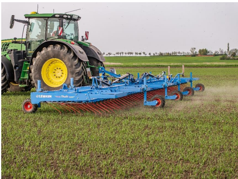
Фото 2: LEMKEN Thulit працює зі сталим тиском на зубцях.
