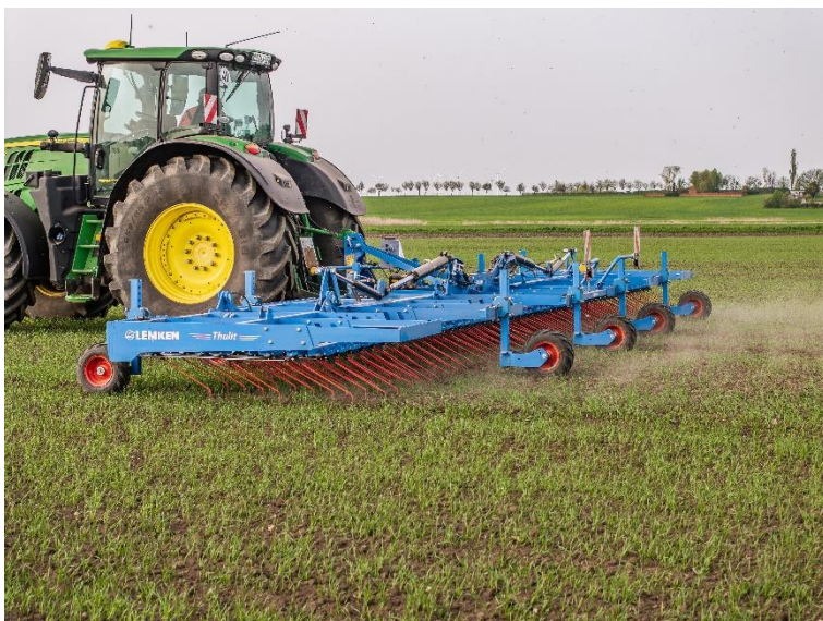
Foto 2: De Thulit van LEMKEN werkt met een constante tandendruk.
