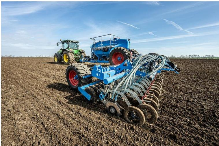
**Bild 2:** Die Trapezkunststoffwalze sorgt für einen ruhigen Lauf der Säscharre und damit für eine exakte Tiefenführung der Säschiene.
