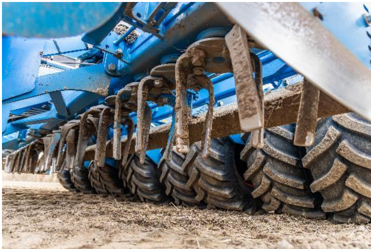
Bild 2: Die LEMKEN Kreiselegge Zirkon sorgt kraftvoll für eine perfekte Bodenstruktur für die folgende Saatgutablage.
