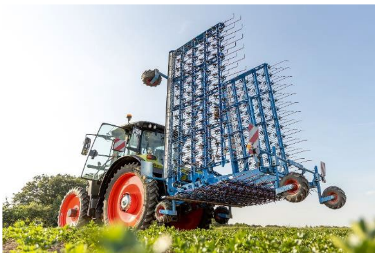
Фото 3: Транспортне положення LEMKEN Thulit з автоматичним складуванням убів
