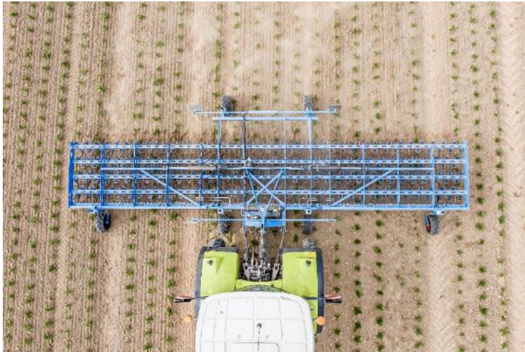
Afb. 2: De wiedeeg Thulit van LEMKEN met vier balken en acht rijen tanden
