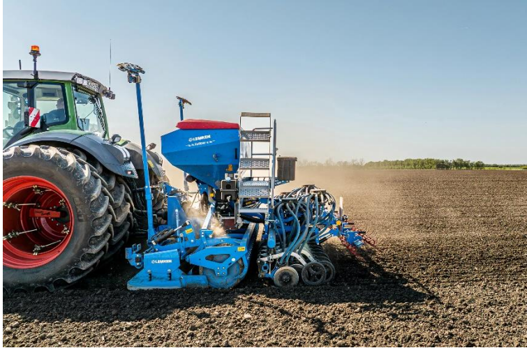
Bild 2: Die Solitair MR wird auf die Walze der Kreiselegge aufgesattelt, so erhält man ein schlagkräftiges Duo.
