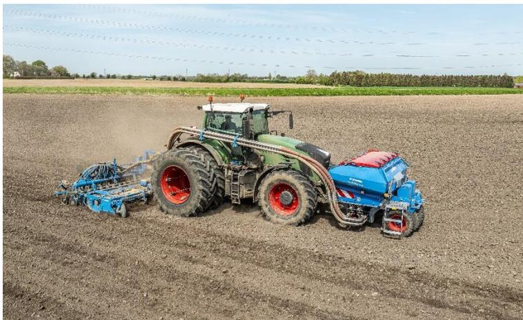
**Image 2:** Le Solitair F de LEMKEN est équipé d'un espace de montage frontal qui peut accueillir, au choix, un rouleau agricole à pneus ou un poids étranger.
