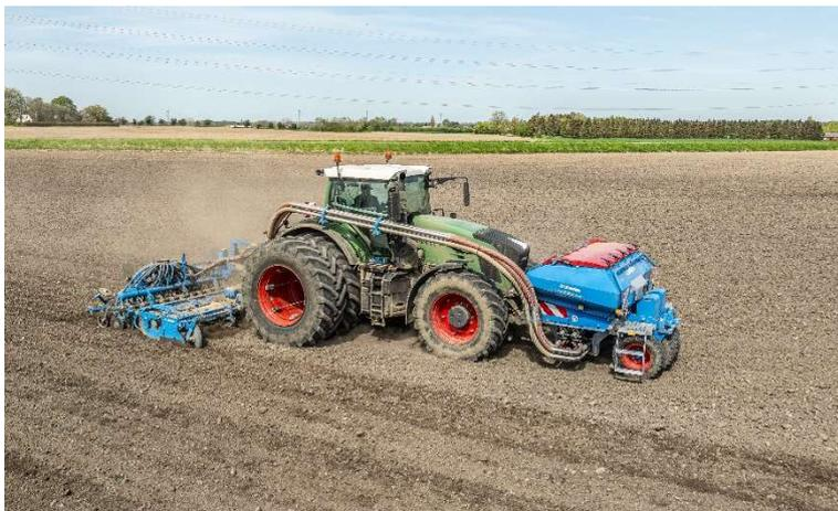
Фото 2: LEMKEN Solitair F має достатньо місця у передній частині, де можна розмістити або ущільнювальний шинний коток, або баласт.
