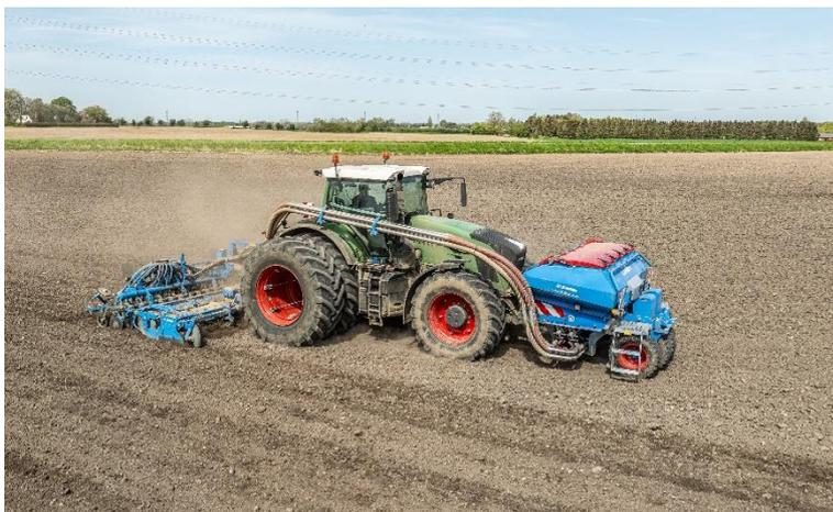
**Bild 2:** Der LEMKEN Solitair F ist mit einem Frontanbauraum ausgestattet, der wahlweise einen Reifenpacker oder ein Fremdgewicht aufnehmen kann.
