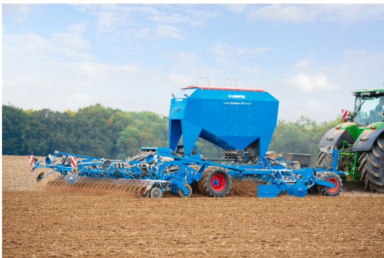
Imagen 1: Combinación de siembra LEMKEN Solitair DT con grada de discos compacta integrada
