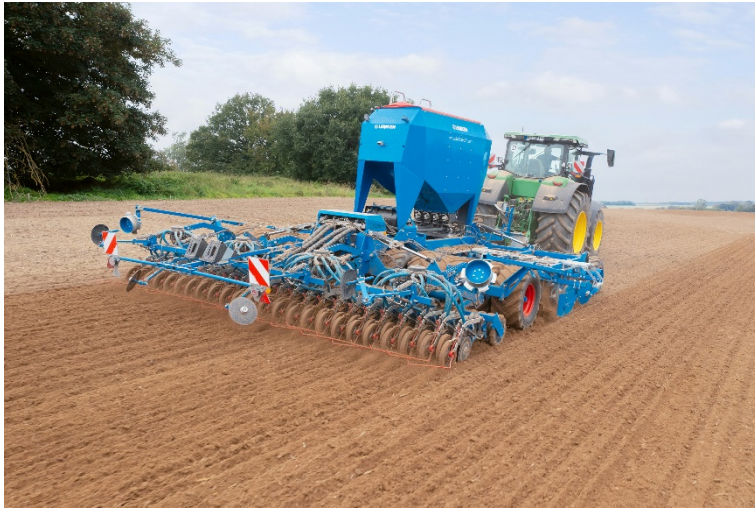
Bild 2: Aussaat mit der Bestellkombination LEMKEN Solitair DT
