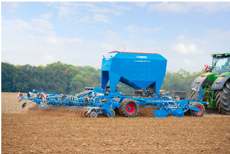
Bild 1: Bestellkombination LEMKEN Solitair DT mit Kurzscheibenegge
