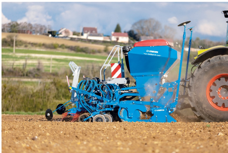
Image 2 : Le Solitaire 9+ Duo avec système à épandage double (Double-Shot)
