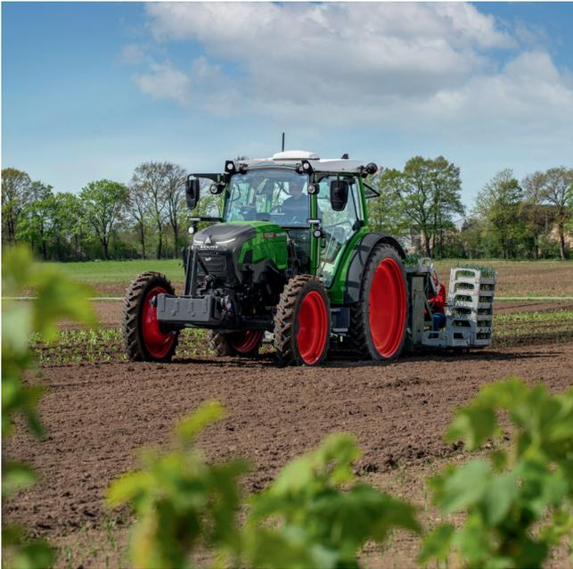
Der CO<sub>2</sub>-Fußabdruck wird für Landwirte immer wichtiger. Fendt bietet schon heute als einziger Hersteller zwei voll batterie-elektrische Traktorbaureihen mit 55 kW Dauerleistung und 66 kW Spitzenleistung für Landwirte an – den Fendt e100 V Vario und den Fendt e100 Vario in der Standardversion.
