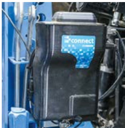
Das Grundmodul mit GPS-Empfänger und GSM-Modem ist vom Pflug auf andere Geräte umsetzbar. Fotos: Böhrnsen
