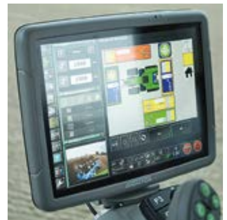
Hier ist iQblue connect aktiv. Es kontrolliert das Steuergerät Nr. 2.
