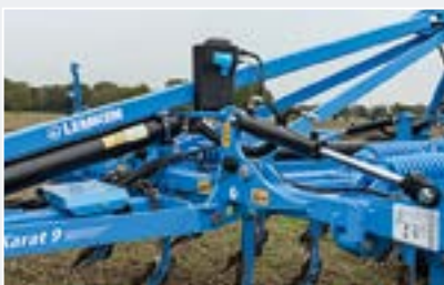
iQblue Connect ermöglicht eine automatische Tiefenverstellung des Grubbers.
