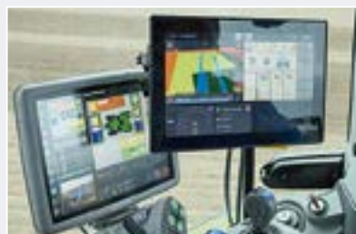
Die farbige Karte gibt die Sollwerte vor, das Terminal (links) zeigt den TIM-Zugriff.
