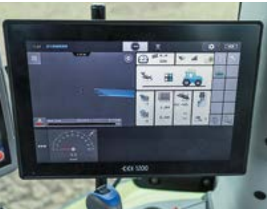
Am CCI-Terminal stellt der Fahrer die Soll-arbeitsbreite und den Verstellbereich ein.
