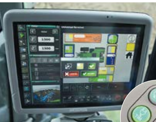
Sobald der Fahrer den TIM-Zugriff erlaubt, wird das Traktor-Geräte-Management aktiv.
