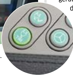
Sobald der Fahrer den TIM-Zugriff erlaubt, wird das Traktor-Geräte-Management aktiv.
