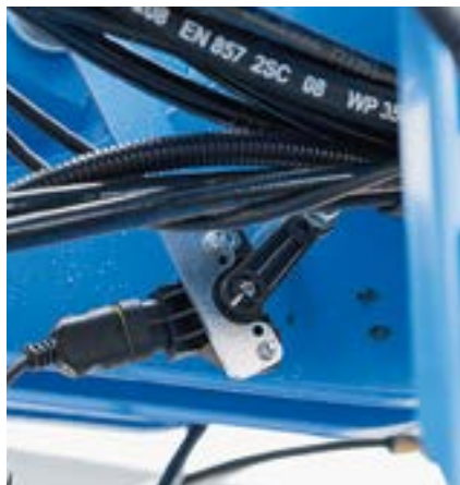
Der nachgerüstete Drehwinkelsensor kontrolliert die Arbeitsbreite des Pflugs.
