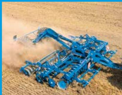
ten Scheibenreihe ein Nivellierstriegel angebracht, der das Stroh besonders bei der Arbeit diagonal zur Druschrichtung gut verteilt.
