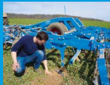
auf den Koralin verzichten. Der wird unter anderem nach milden Wintern in nicht abgefrorenen Ölrettich-Gelbsenf-Zwischenfruchtbeständen eingesetzt. Die Schare schneiden die Ölrettichwurzeln knapp unter der Bodenoberfläche und verhindern den Wiederaustrieb. Außer-
