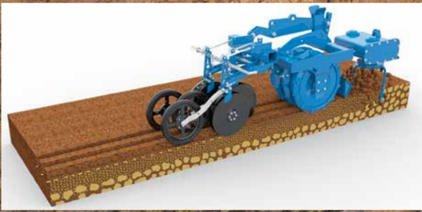
durch die Trapezringe, die exakt im Abstand der nachfolgenden Drillreihen arbeiten. Die Böden behalten eine raue Oberfläche mit viel Feinboden und neigen so weniger zur Verschlammung. Es wird eine besonders gleichmäßige Ablagetiefe und ein optimaler Bodenschluss für das Saatgut erzielt. Ihre besonderen Kennzeichen sind Hartmetallabstreifer, • hohe Tragfähigkeit auf mittleren und schweren Böden, • nahezu universelle Verwendbarkeit und • eine geringe Anfälligkeit für anklebende Erde.
