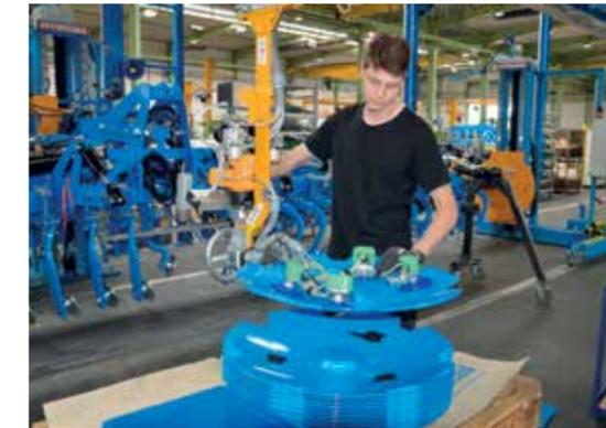
↑ Poste de travail ergonomique : un appareil de levage déplace les disques crénelés sans mal de dos pour l'opérateur.
