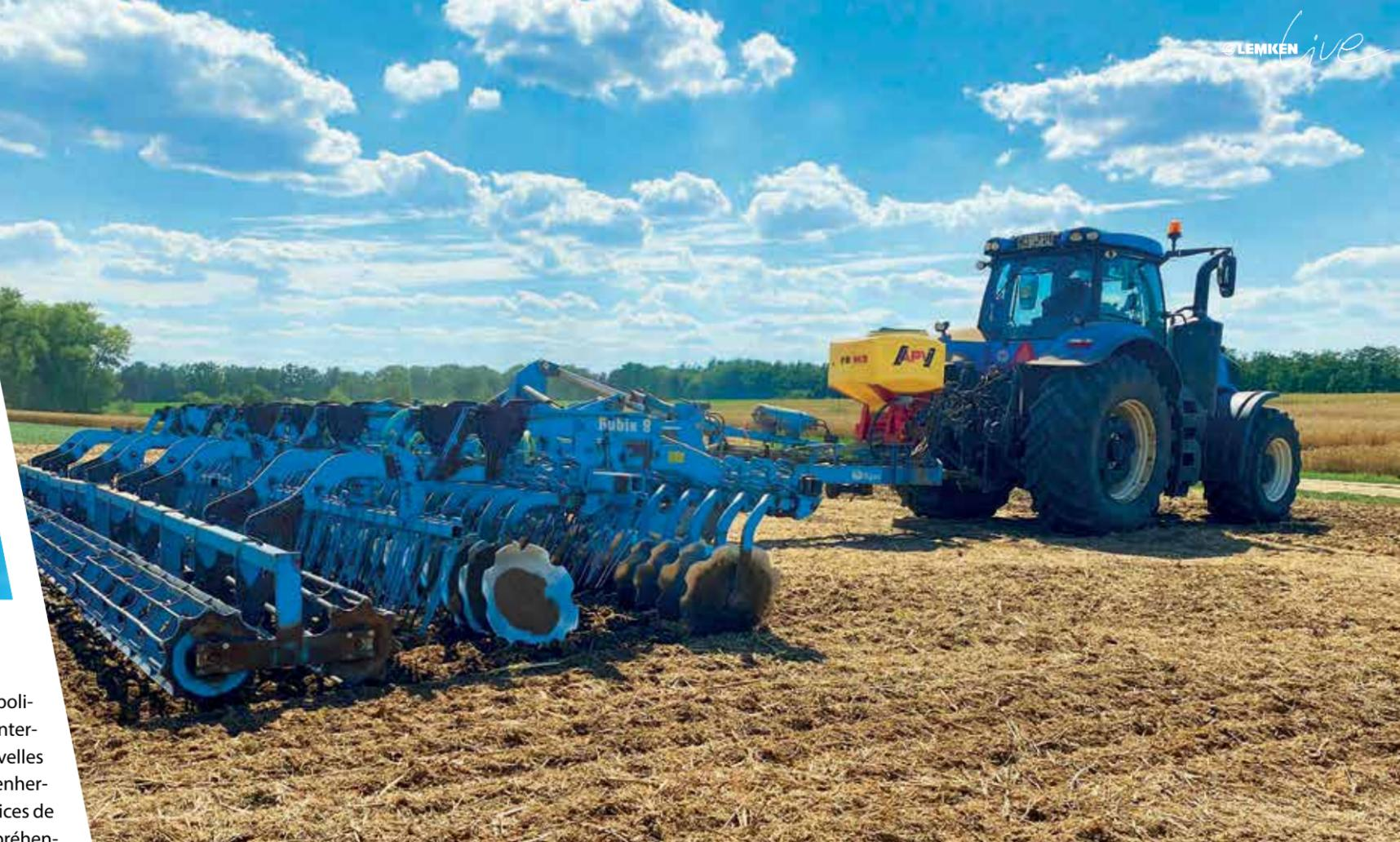
Un déchaumeur à disques indépendant Rubin 9 d'une largeur de travail de huit mètres en activité sur le châssis-porteur Gigant.
