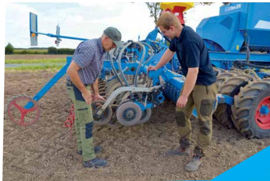
Les socs à double disque du Compact-Solitaire 9 HD avec roue plumbeuse à l'arrière garantissent une précision de semis parfaite et un recouvrement uniforme.
