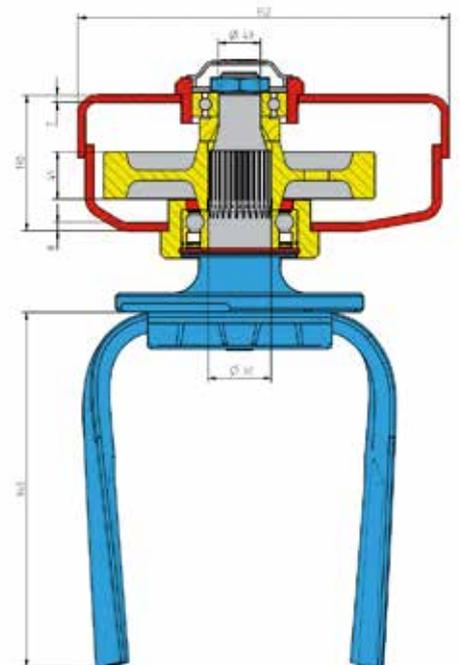
Корпус из толстостенной высококачественной стали (все данные в мм)
