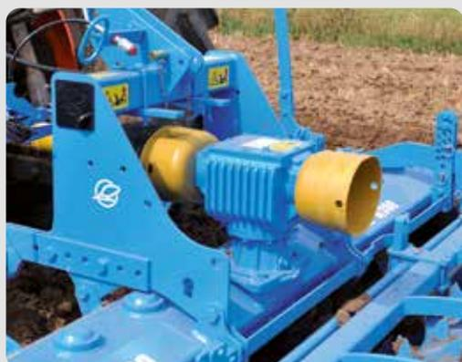
**Простая силовая передача через редуктор со сменными шестернями**
