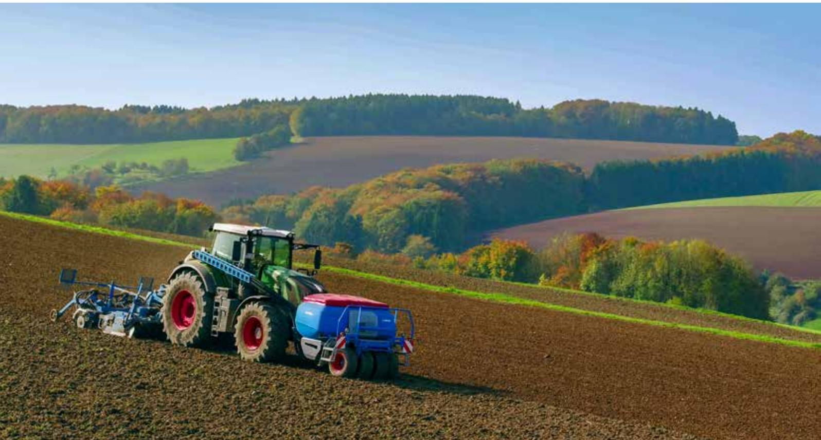
Передний бак Solitair 23 легко комбинируется с пунктирной сеялкой Azurit или высевающей секцией OptiDisc 25. За счет этого его можно эффективно использовать весь год. Оптимальное распределение веса передней и задней комбинации обеспечивает не только безопасное управление машиной, но и возможность использования менее мощных
