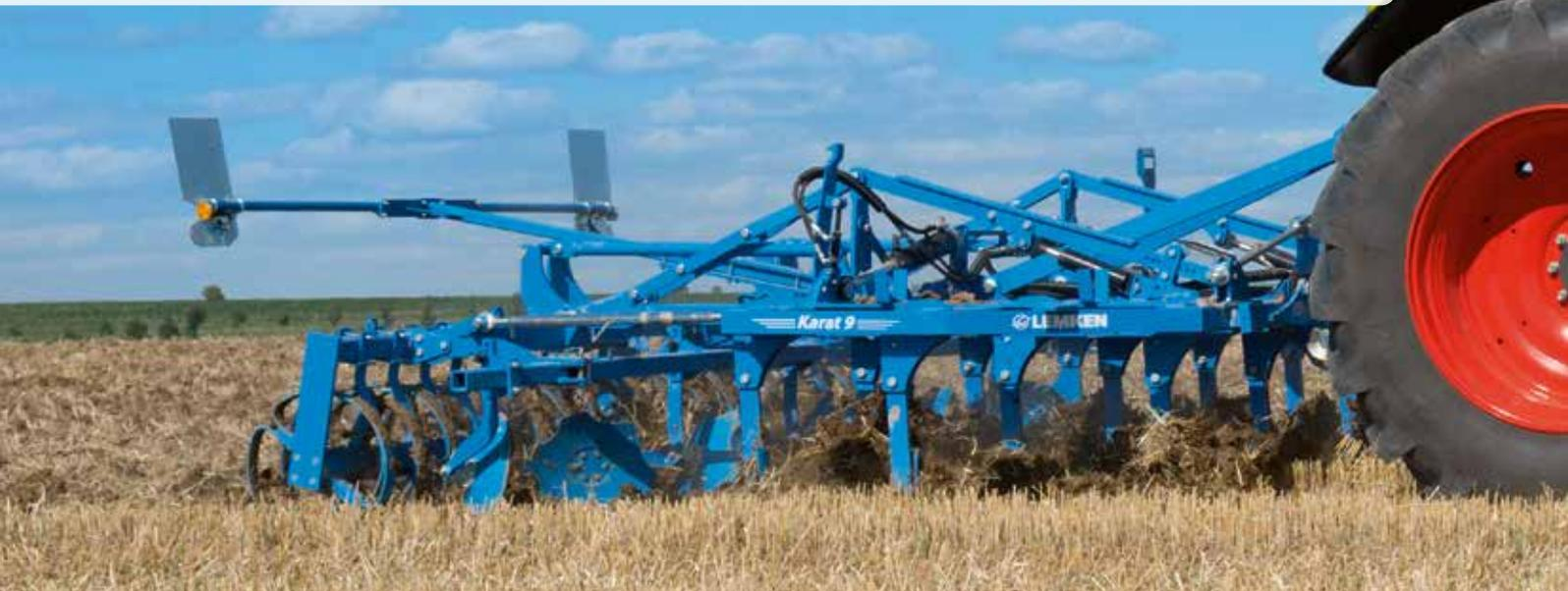
При ширине захвата от трех до семи метров лапы культиватора для интенсивной обработки Karat 9 устанавливаются на раму культиватора со средним шагом около 28 см. Этим достигается тщательное смешивание соломы с почвой. Симметричное расположение лап обеспечивает работу без бокового увода.
