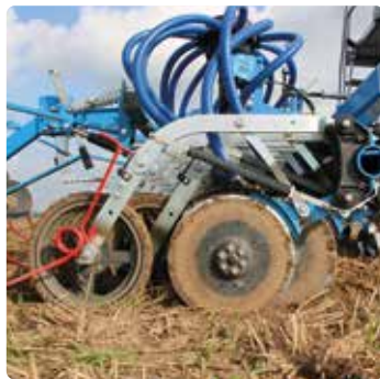
Het Optidisc dubbelschijfzaaikouter mechanisch tot 45 kg kouterdrukverstelling
