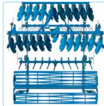
Geen zijwaartse trek bij symmetrische plaatsing van schijven
