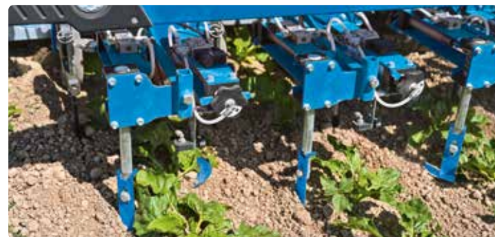
Camera's met beschermende behuizing en pneumatisch aangedreven, sikkelvormige schoffelmessen voor elke rij
