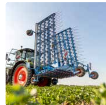
Inklapbare tanden voor een veilig vervoer over de weg
