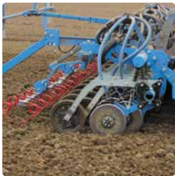
Het Optidisc dubbelschijfzaaikouter hydraulisch tot 70 kg kouterdrukverstelling
