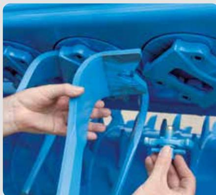
**Remplacement d'une dent à démontage rapide**
