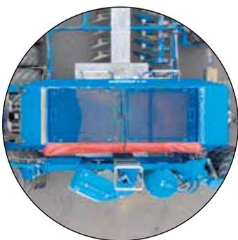
**Trémie simple ou à deux compartiments avec large ouverture**
