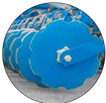
**Zone de disques à réglage hydraulique (en option)**
