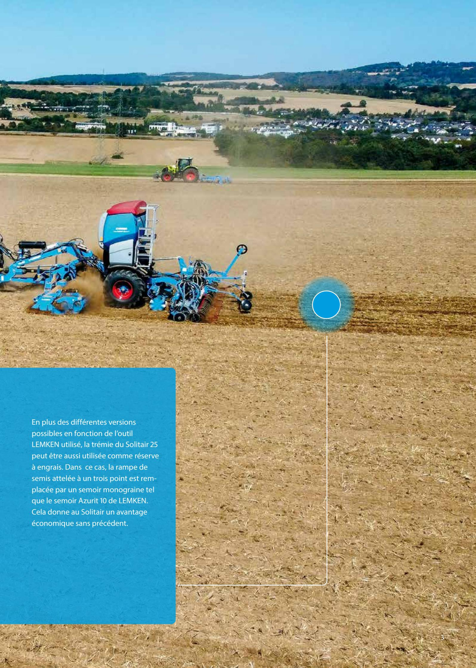
En plus des différentes versions possibles en fonction de l'outil LEMKEN utilisé, la trémie du Solitaire 25 peut être aussi utilisée comme réserve à engrais. Dans ce cas, la rampe de semis attelée à un trois point est remplacée par un semoir monograine tel que le semoir Azurit 10 de LEMKEN. Cela donne au Solitaire un avantage économique sans précédent.
