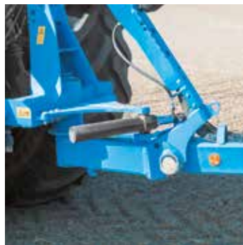
La tête de charrue Diamant 16 avec le système de réglage OptiLine
