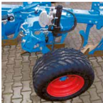
Réglage hydraulique de la profondeur de travail
