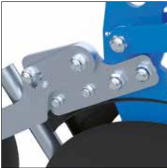
Réglage séparé de la profondeur en option sur chaque deuxième soc de semoir
