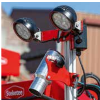
Projecteur à LED capable d'éclairer jusqu'à cinq rangs
