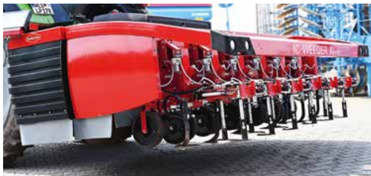
Caméras avec boîtier de protection et lames de binage pneumatiques en forme de faucille pour chaque rang
