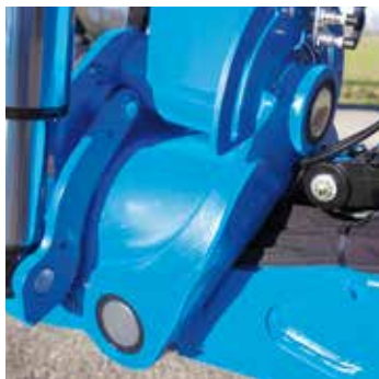
Axes munis de bagues oscillantes
