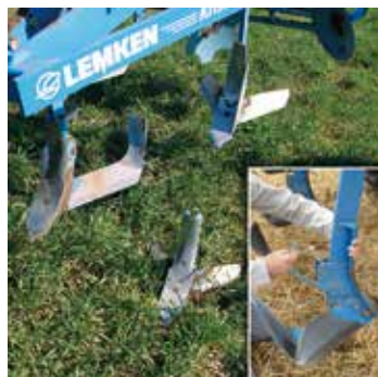
Remplacement de socs TriMix par socs DuoMix
