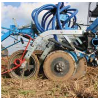
Soc à double disque OptiDisc, mécanique jusqu'à 45 kg la pression des éléments semeurs
