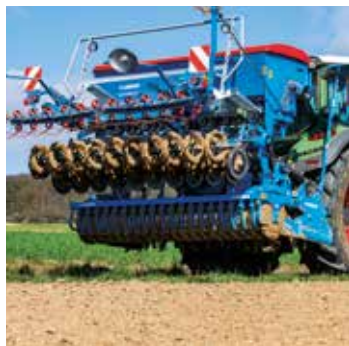
Déplacement hydraulique du centre de gravité
