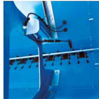
Trémie avec renforts évidés pour un flux sans obstacle
