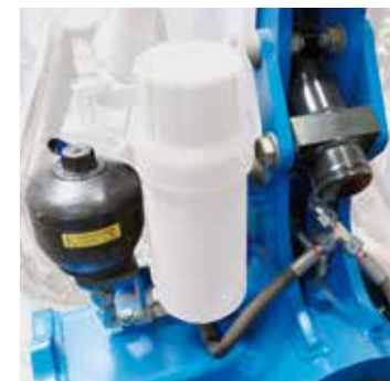
Vérin d'amortissement dans la tête de charrue
