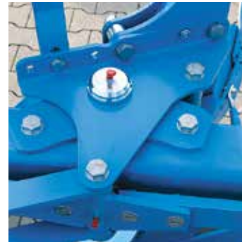
Réglable hydraulique de la largeur de travail (Titan 18 V uniquement)
