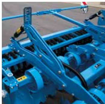
Réglage hydraulique de la profondeur de travail
