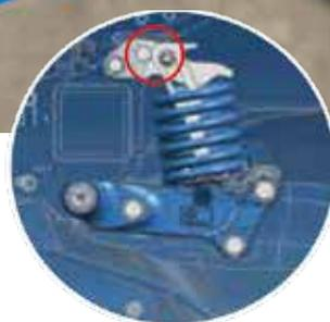
Après déclenchement, l'élément redescend sous l'action du ressort. La butée peut redescendre, transmettant au sol l'énergie de rappel du ressort.
