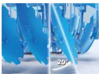
Les disques sont inclinés à 20° par rapport au sol et à 16° sur la première rangée et à 14° sur la dernière rangée par rapport au sens de la marche. La pénétration est optimale et permet un travail sur toute la surface pour atteindre un bon mélange et un émiettement optimal.
