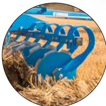
**Des disques concaves crénelés à faible usure**
