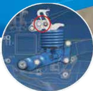
Au déclenchement, le ressort est comprimé, la butée reste en position haute.
