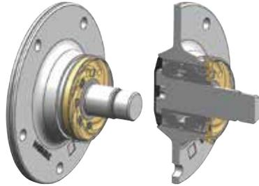
Le couple de ventilation guide la poussière et l'humidité vers l'extérieur du palier. Un joint cassette à 6 lèvres protège l'intérieur.
