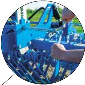
**Réglage centralisé de la profondeur**
