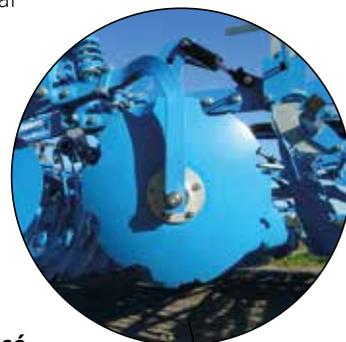
**Réglage de la profondeur centralisé**
