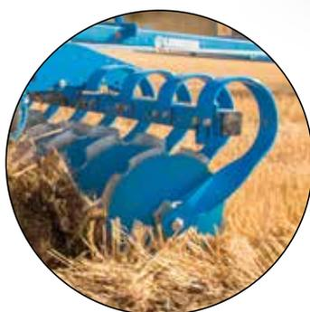
**Des disques concaves crénelés à faible usure**
