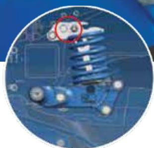
Face à un obstacle, les disques montent individuellement, avant d'être rapidement ramenés en position de travail. À ce stade, le ressort hélicoïdal pousse la butée vers le haut.
