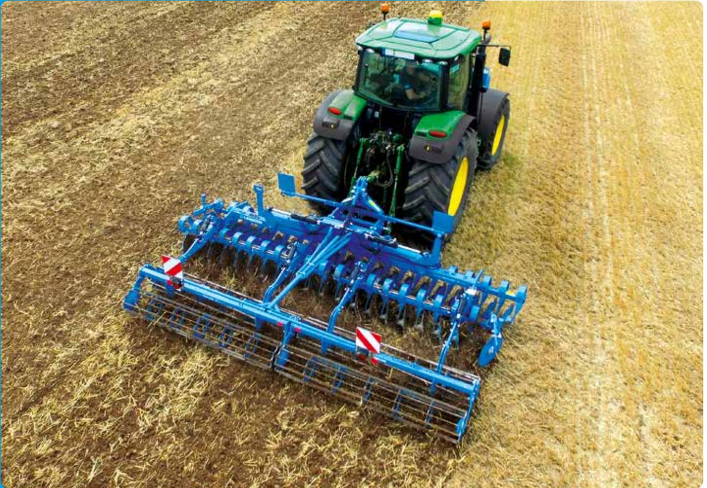
Die Doppelwalzen bestehen aus zwei Walzen mit je 400 mm Durchmesser oder je einer Walze mit 540 mm und 400 mm Durchmesser. Die Walzen sind pendelnd aufgehängt und haben so eine optimale Boden Anpassung. Sie sorgen für eine exakte Tiefenführung des Bodenbearbeitungsgeräts.
