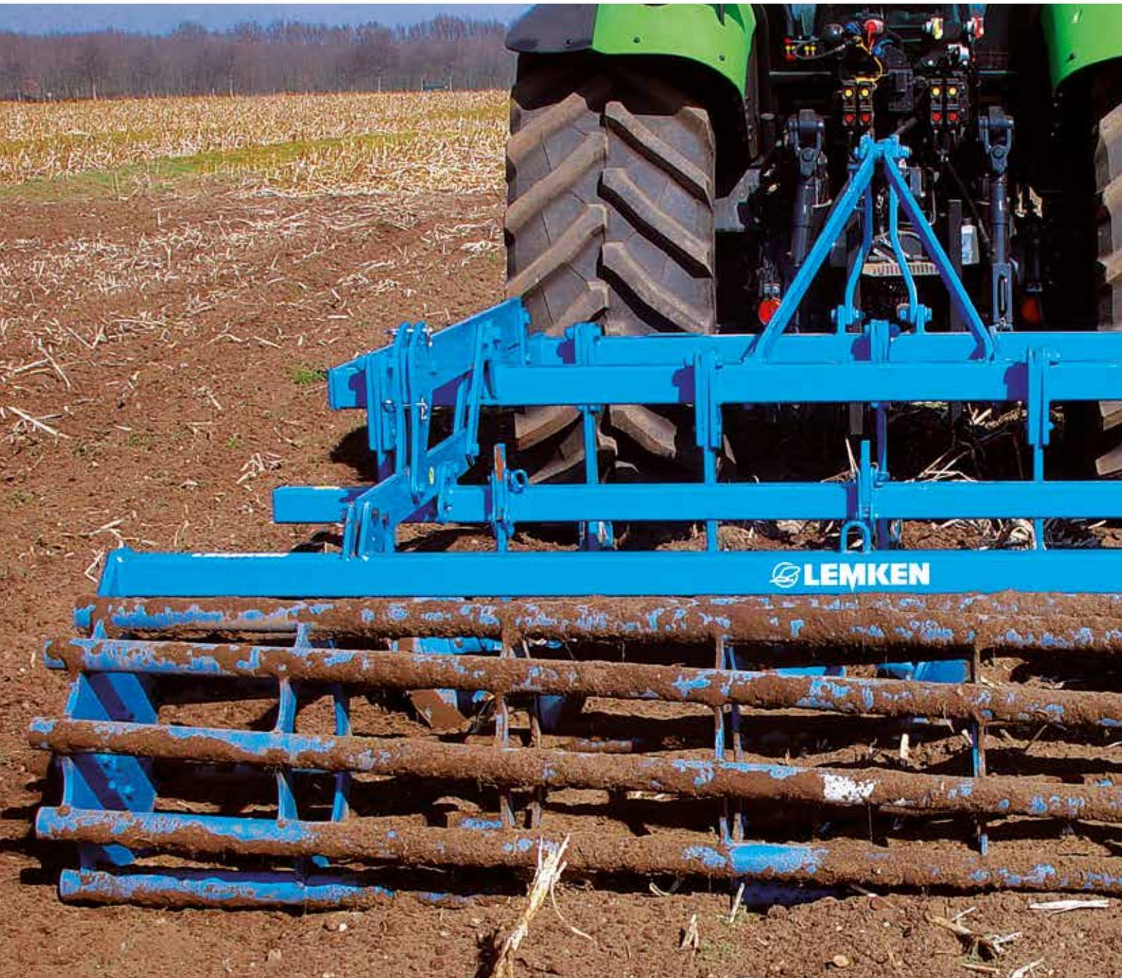
Die Rohrstabwalzen werden mit 400 mm, 540 mm und 600 mm Durchmesser angeboten. Sie stellen eine einfache und preiswerte Möglichkeit dar, Anbaugeräte in der Tiefe zu führen und den Boden rückzuverfestigen. Die Rückverfestigung wirkt streifenweise quer zur Fahrtrichtung. Die Walzen mit kleinem Durchmesser haben eine gute Krümelung bei geringem Gewicht.
