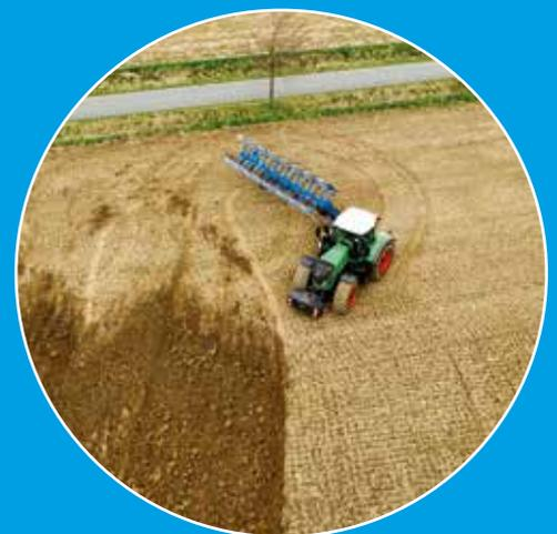
Der große Freiraum zwischen Pflugturm und Traktor sichert den Einschlag bis 90°. Durch den Drehvorgang des Pfluges wird das Aufsattelrad automatisch gelenkt. Das optimale Zusammenspiel von Drehwerk und Aufsattelrad ermöglicht auch in hügeligem oder schwierigem Gelände den schnellen und einfachen Wendevorgang auf einem schmalen Vorgewende.
