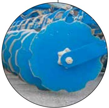
**Zone de disques à réglage hydraulique**
