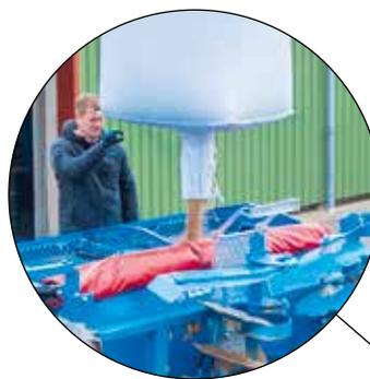
**Bâche enroulable ou couvercle résistant à la pression** pour un remplissage simple
