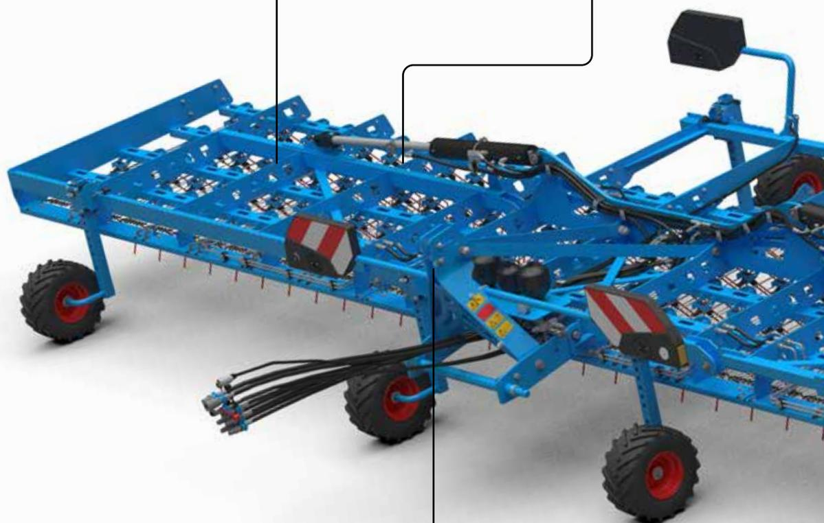
**Concept de châssis à quatre poutres**
