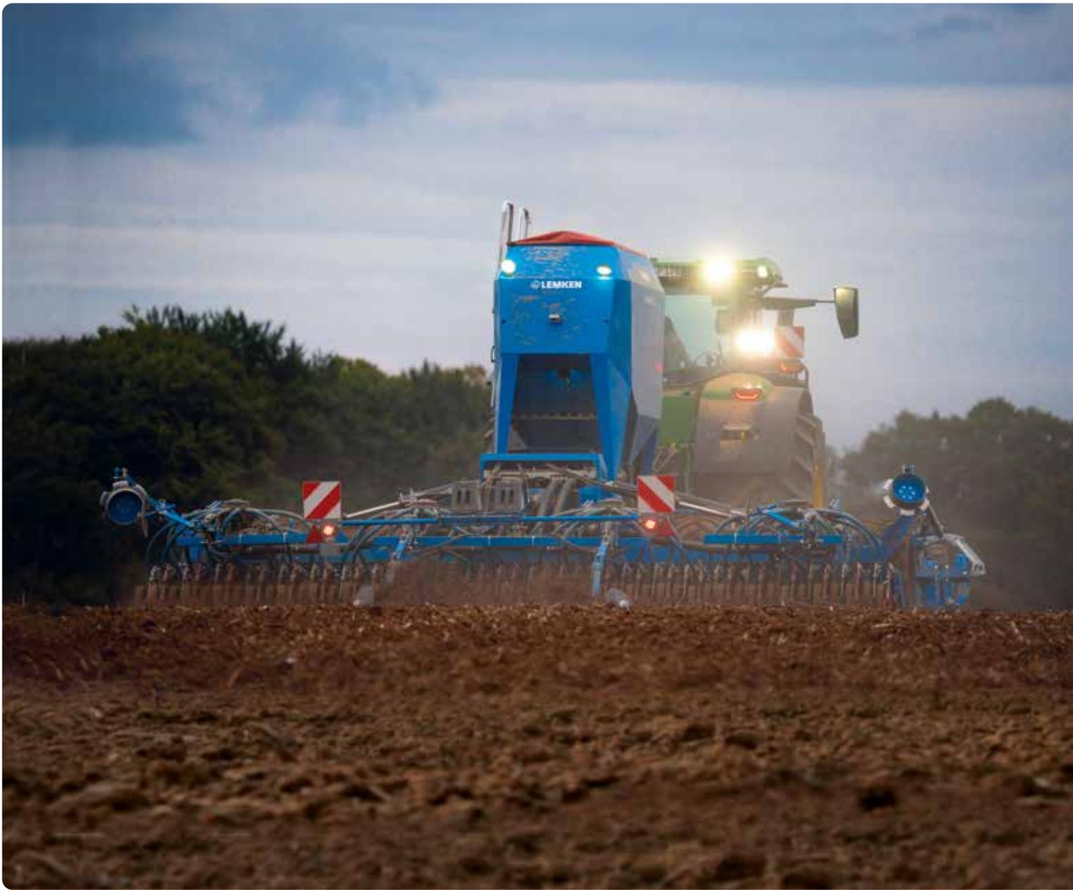
Le puissant éclairage du **Solitair DT** permet une vue optimale pour un semis soigneux, même la nuit. Un éclairage de la zone d'étalement est également disponible en option.
